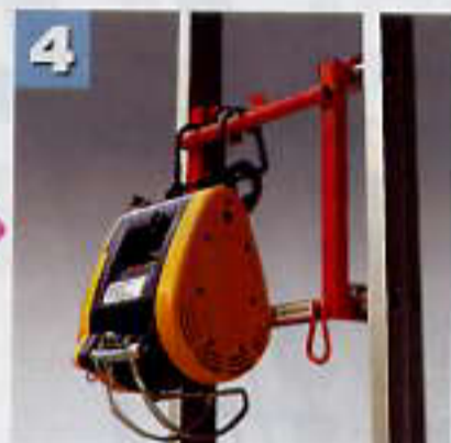
4 ウインチをレールに引っ掛けワイヤーを通してセット完了
